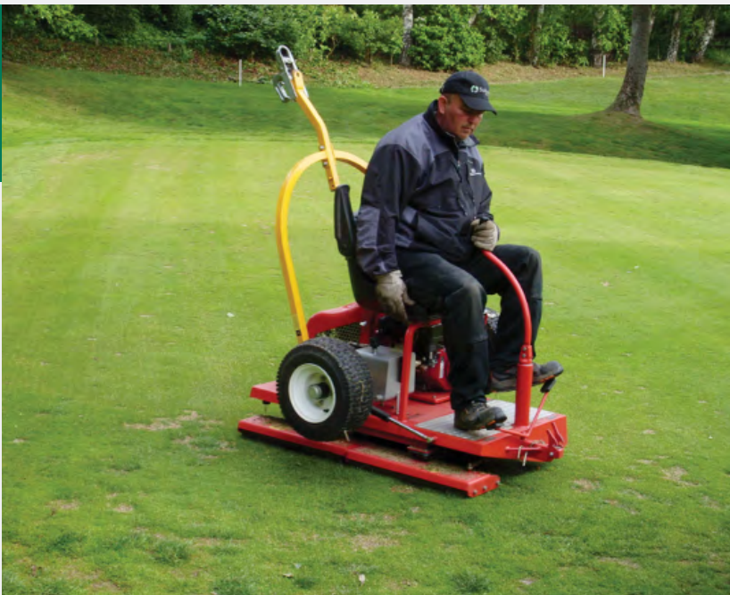
AGC har altid været med på vognen vedrørende moderne banepasning. Her ses Jackie Larsen på en "rystepudser", der jævner overfladen på greens og gør dem hurtigere.
